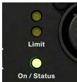
図20:ULTRA-X40/42のリミットLED
