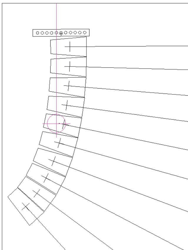
図24：MAPPによるLINAアレイの重心位置の表示
