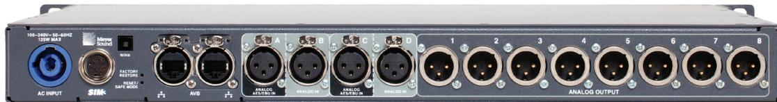
Galileo® GALAXY™ 408ネットワークプラットフォームは、Meyer Soundスピーカーシステムを包括的にコントロールするオーディオプロセッシングおよびスピーカー管理ツールです。パワフルなオーディオプロセッシングとともにオープンソースのAVBテクノロジーを活用したGALAXYプロセッサーは、1つのプラットフォームで完全なシステム管理を実現し、ツアーから固定設備まであらゆる用途に理想的な選択肢となります。
