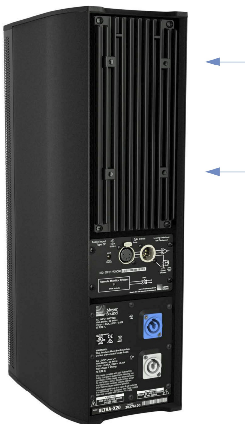
ULTRA-X20 ヒートシンク サードパーティ製アクセサリ 取付対応 5 インチ × 2.75 インチ (127 mm x 70 mm) の ホールパターン
