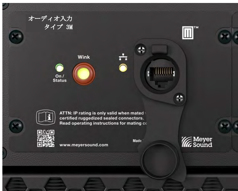
タイプ 3M Milan エンドポイントモジュール、On/Status LED、Wink ボタン/LED、ネットワーク接続 LED、およびネットワークコネクタ
