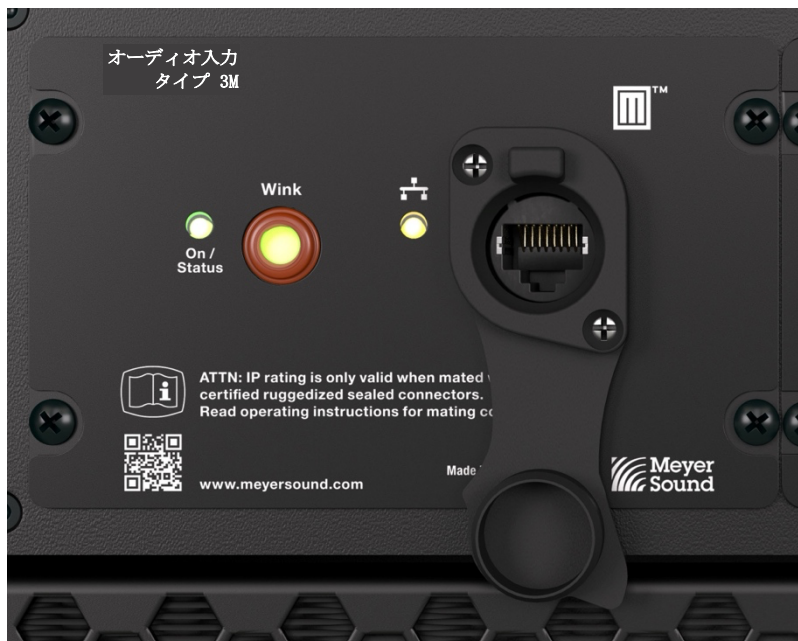
タイプ 3M Milan エンドポイント・モジュール、オン/ステータス LED、Wink ボタン/LED、ネットワーク接続 LED、およびネットワークコネクター（または ネットワーク接続端子）
