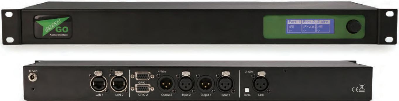
オーディオ入力/出力インターフェースは、既存のマトリックスまたは他のアナログインターフェース製品（オーディオ入力/アナウンス）に接続します。基本的なアナログ2ワイヤーインターカム（パーティーラインシステム）は、専用2ワイヤーXLRポートに接続します。デュアルイン/アウトXLRポートは、2つの別々のオーディオ信号（またはステレオ信号）をGreen-GOネットワークに組み込み、同じイーサネットネットワーク上に送信することができます。
