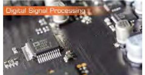
強力な内蔵デジタル信号プロセッサにより、ハイパスフィルター、パラメトリックイコライゼーション、ダイナミックコンプレッション、細かいデジタルゲイン調整が可能です。
