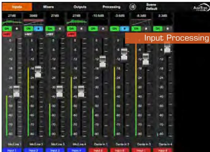
**入力処理ブロック**は、最大4つのマイク/ラインまたはデジタル入力と4つのDante入力を管理します。4つのダイレクトアウト（プリアンプのゲインまたはフェイズインバーター処理直後）と、ミキシング処理とアウトプット処理に送られる8つの処理済み入力を提供します：
